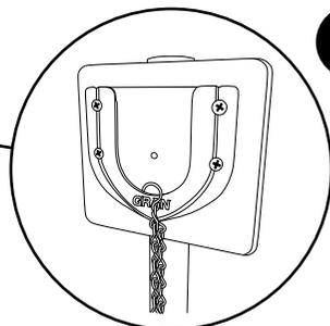
ブルの高さ確認するためにチェーンを使用します。中間あたりにあるフックをブラケットに引っ掛けて垂直に垂らして下さい。
