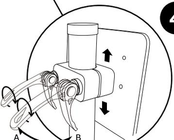
高さの調節をブラケットの裏側で行います。レバーをA方向に上げると高さ調整ができ、回転させることで固定することができます。高さ位置が決定したらレバーをB方向に下げしっかりとホールドします
