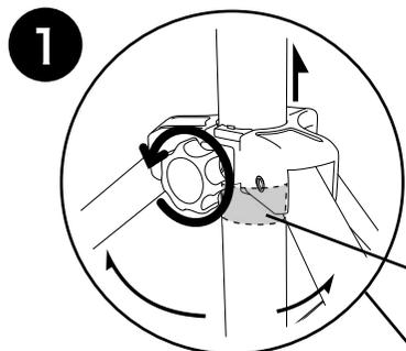
最初に足場を固定します。ホールドネジを緩めて三脚部分を広げて連結部をイメージのようにラベルの位置に合わせてからしっかりと固定します。
