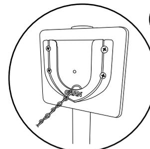
高さを固定できたら、ブラケットに引っ掛けていたチェーンのフックを端のフックに引っ掛け直します。右図のように斜めに伸ばすと輪の先端がスローライン位置になります。
